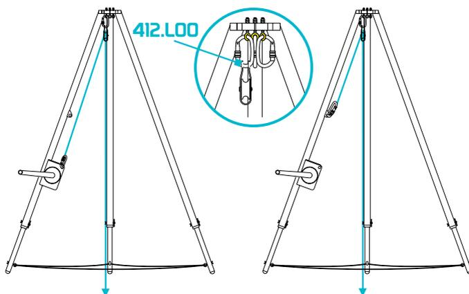
**Fig. 6 –Sollevamento con l'argano (I) –** Tramite l'argano (I) si possono manovrare corde semistatiche (EN 1891) di diametro compreso tra 10 e 12 mm per sollevare un carico massimo di 1,5 kN per l'intera lunghezza della corda.
